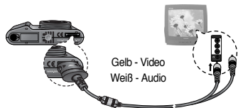
(Anschluss des AV-Kabels an die Kamera)
